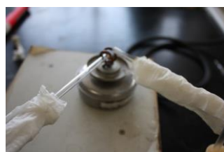
I 電動ブクで空気を送り込む J 茶こし L KCl+メタノール M 茶こしゼオライト
