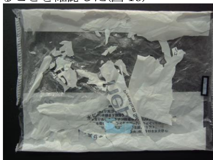
図 18 劣化したポリプロピレンの袋
