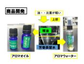
別々にして水蒸気蒸留を実施します。スライドのように精油成分は比重が軽いので 上部へ、水分は下部へ分離します。
