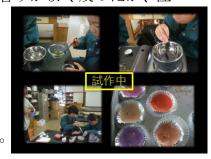
を添加し、容器に燃え芯を置き、静置、固化させます。ろうの量を固定し、クロモジオイルの添加量を変化させます。この結果、ろう15gにオイル1.2gが適当でした。
