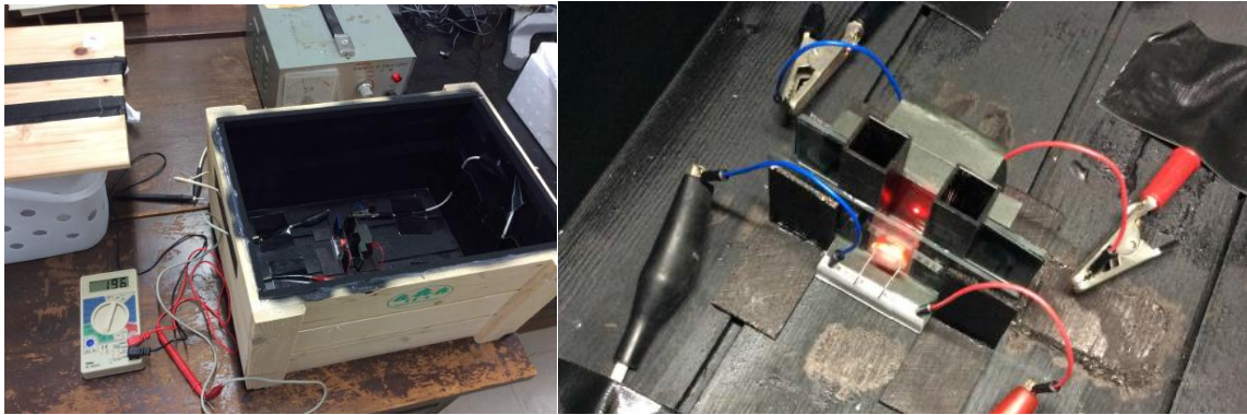
図1 作成した吸光光度計（左：全体、右：光源および検出部）
