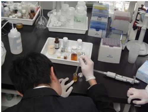
図 18 模擬溶液からパラジウムを分離
