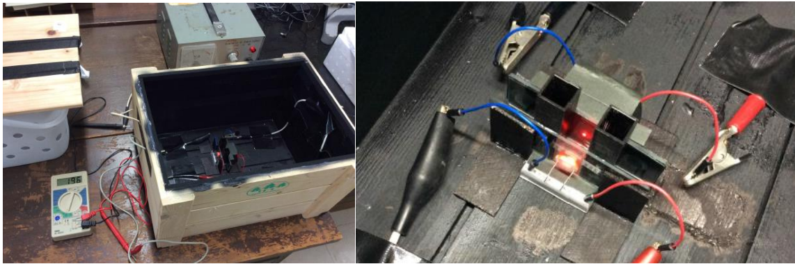
図1 使用した吸光光度計（左：全体、右：光源および検出部）
