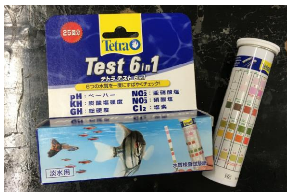
図1 テトラ テスト 6 in 1 試験紙
