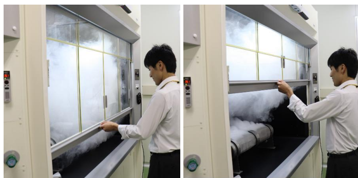
【封じ込め性能を可視化した様子】 前面扉を閉じている時は低風量で排気、扉を開けると1秒程度で適切な風量が確保され、局所排気装置内で焚かれたスモークがしっかり封じ込められている。
