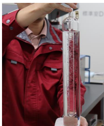
【水の三重点を実現するための装置】 ※0.01℃を担保する
