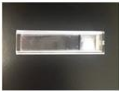
図2 日焼け止めを塗布した プラ板をセルに入れた様子
