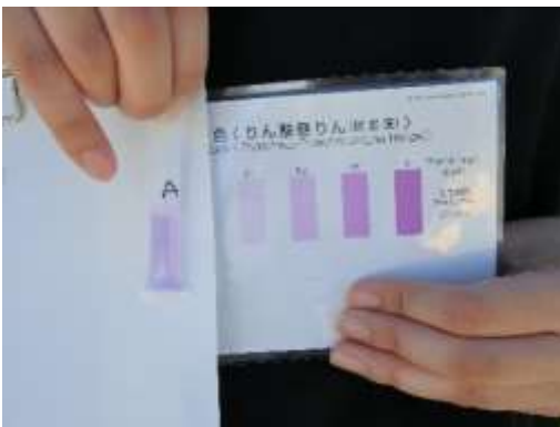
図2：パックテストを用いて計測する様子
