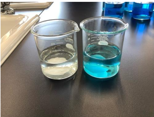
写真1 酸化チタンの水質浄化の効果 (左からCMCF+TiO 2 ゲル、CMCFゲル)
