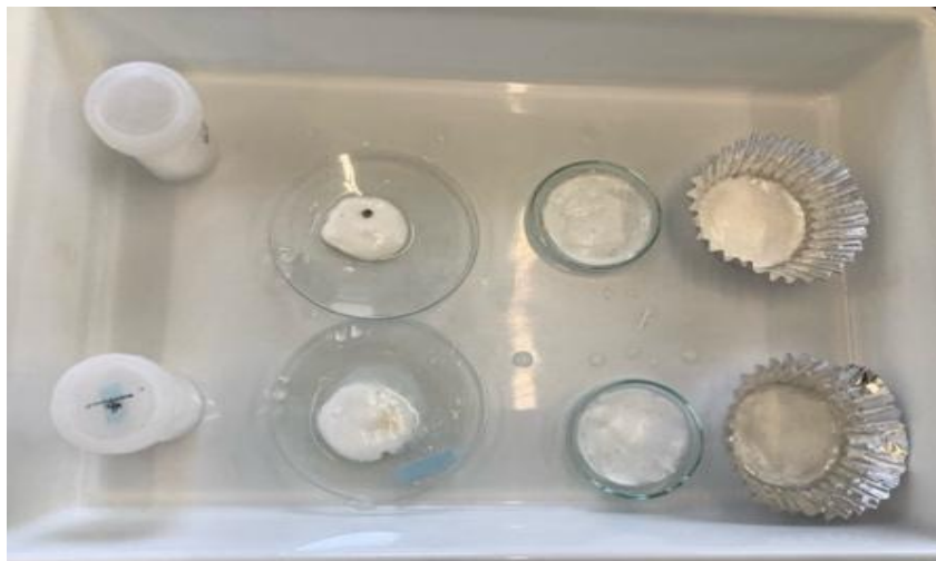
写真5 異なる容器を用いたゲル作製 (左から、筒型、時計皿、シャーレ、アルミカップ)
