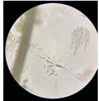
写真3 10/18 600倍 採取した鉄バクテリアに薬品滴下
